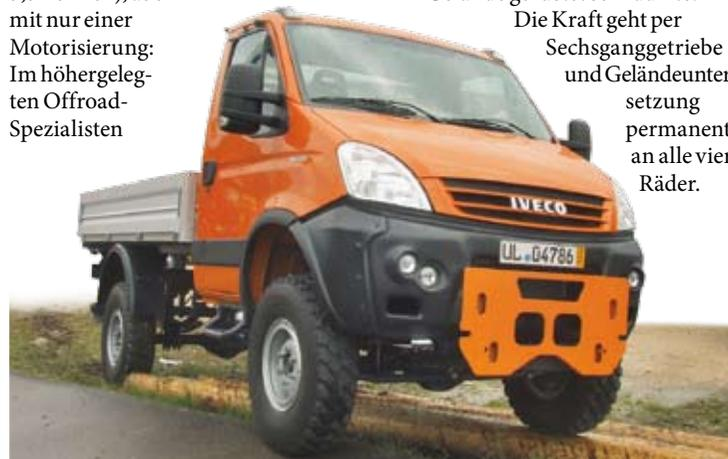
kommt ausschließlich der bärenstarke HPT-Diesel zum Einsatz, der mit einer Leistung von 176 PS und einem Drehmoment von 400 Newtonmetern bestens für schweres Gelände gerüstet sein dürfte.
